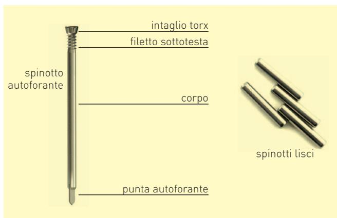
Gli spinotti autoforanti non necessitano del preforo. Forano contemporaneamente acciaio e legno e possono essere applicati con avvitatori. Il foro nella piastra deve avere diametro pari a quello dello spinotto aumentato di un millimetro. Non deve essere effettuato contemporaneamente alla foratura
