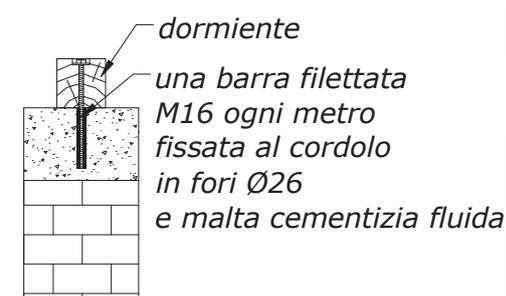
Il dormiente viene fissato per mezzo di barre filettate; il contatto diretto e continuo con il cordolo in cls può causare degrado per fenomeni di condensa. È bene utilizzare specie durevoli (quercia, castagno, larice).
