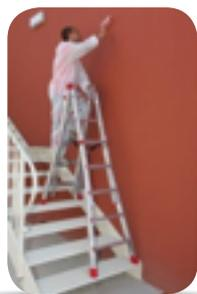
**SCALA:** possibilmente **leggera e resistente**, quindi facile da spostare. Talvolta può essere anche del tipo trasformabile, dotata di snodi multipli, per diventare da scala semplice a cavalletto o scala lunga.
