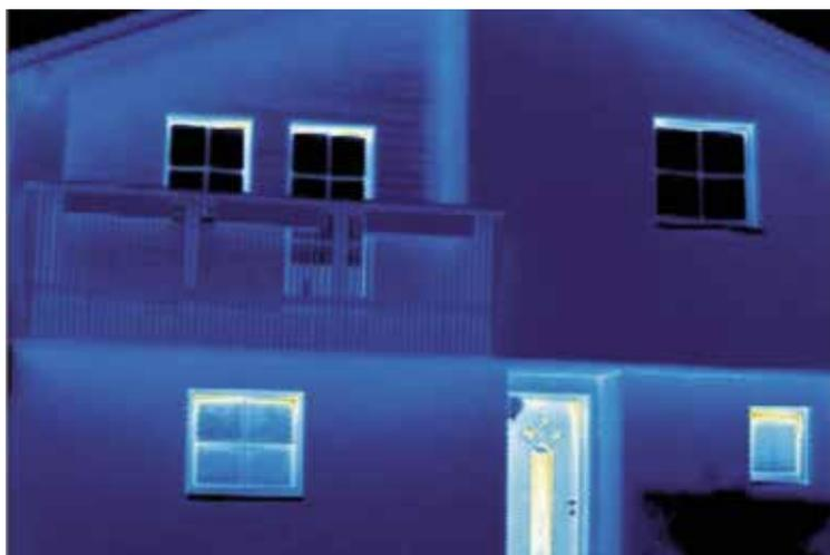
Figura 1A - Termografia di cappotto realizzato correttamente con il giusto accostamento delle lastre
