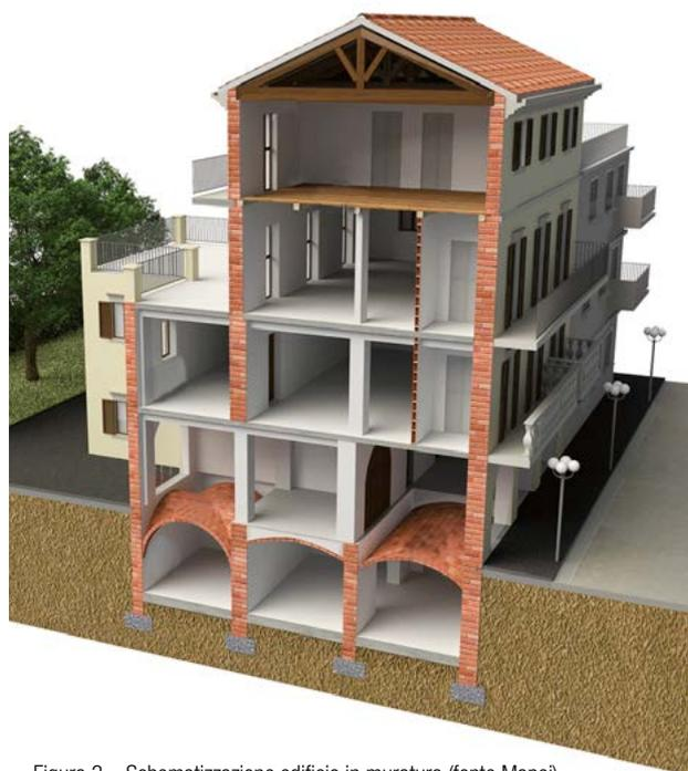
Figura 3 – Schematizzazione edificio in muratura (fonte Mapei)
