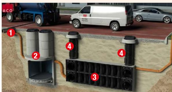
L'acqua piovana entra nel sistema di infiltrazione ACO STORMBRIXX (3) attraverso i canali di drenaggio (1) e passando attraverso un sedimentatore di fango e/o un separatore di idrocarburi/metalli pesanti (2) in modo che nello STORMBRIXX entri solo acqua pulita. Sistemi di ventilazione/ispezione (4) completano il sistema.
