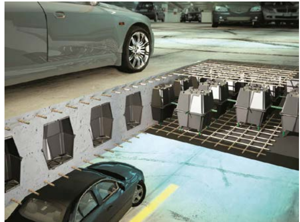
Figura 9 – Elementi modulari in plastica riciclata progettati per l'alleggerimento dei solai in cemento armato in sostituzione delle pignatte laterizie
