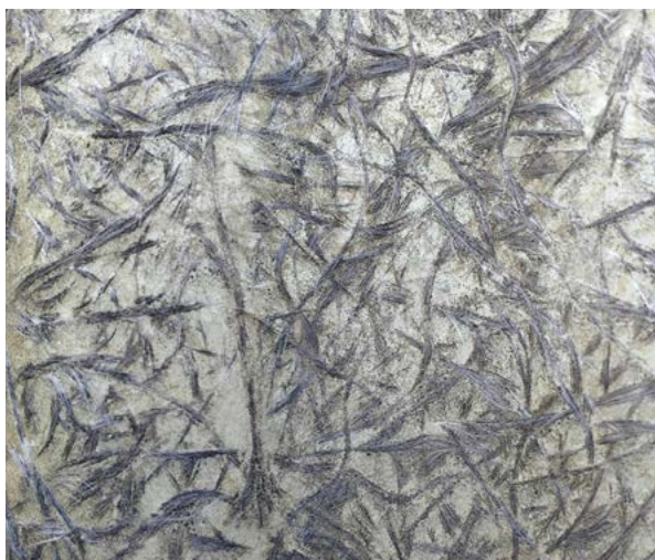
Figura 7 – Il tipico aspetto della vetroresina
