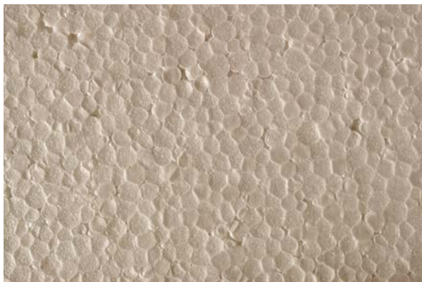
Figura 2 – Il tipico aspetto del polistirene o polistirolo espanso
