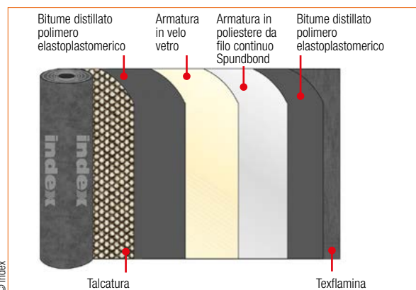
Figura 12 – Esempio di guaina bituminosa con armatura di rinforzo in poliestere
