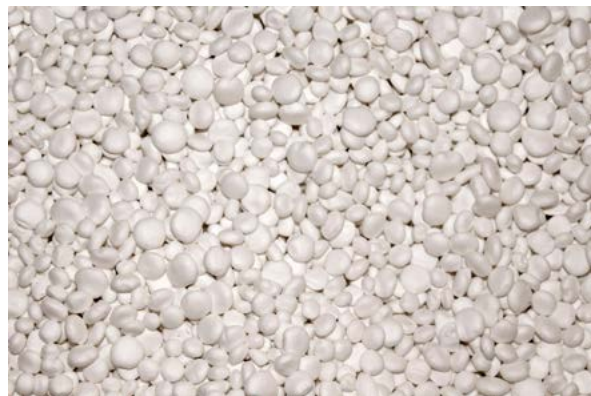
Figura 3 – Sferette di polistirene usate come materiale da imballaggio e nell'isolamento termico di sottotetti e intercapedini murarie
