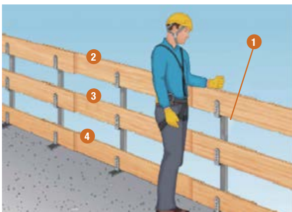
Figura 4 – Parapetti provvisori. Elementi costituenti: 1) montante, 2) corrente principale, 3) corrente intermedio, 4) tavola fermapiè. I parapetti provvisori vengono divisi in tre classi (A, B, C) in base ai requisiti prestazionali che devono soddisfare. Parapetti di CLASSE A resistono solo ai carichi statici di una persona che si appoggia da ferma oppure si sostiene durante il camminamento; non possono essere usati in caso di pendenze della copertura superiore a 10°. Parapetti di CLASSE B resistono a forze dinamiche di debole entità: possono fermare la caduta di una persona che cade su una copertura di pendenza massima di 30°; possono essere usati in caso di coperture con pendenze da 30° fino a 45° purché l'altezza di caduta sia contenuta in 2 m. Parapetti di CLASSE C resistono a forze dinamiche di elevata intensità e possono fermare la caduta di una persona che opera su una copertura con inclinazione di 45°. Ne è consentito l'uso per pendenze tra i 45° e i 60° purché l'altezza di caduta sia contenuta in 5 m.
